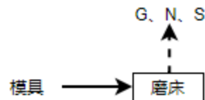
图 2-8 模具打磨工艺流程及产污节点图
