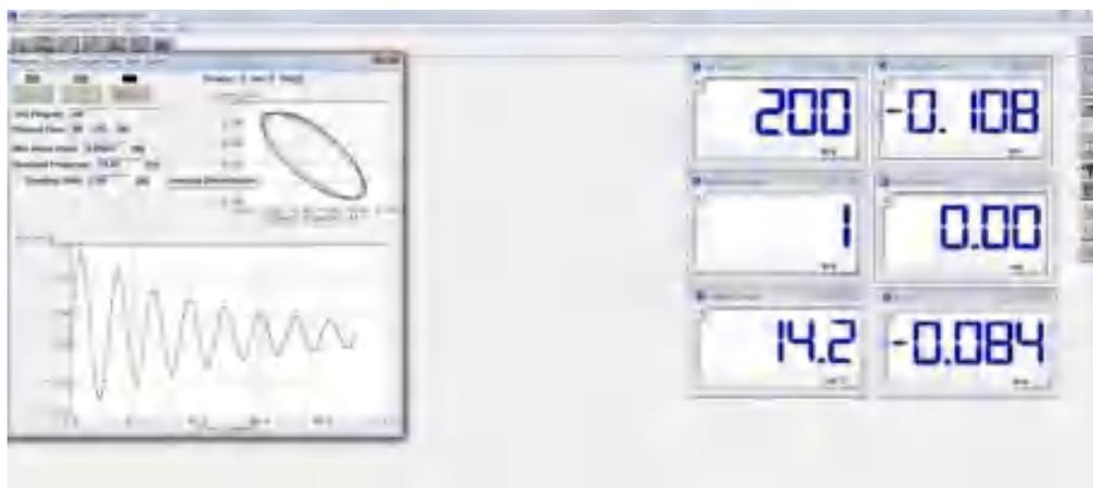
图 4.3.2 典型的滞回圈和振动衰减曲线
