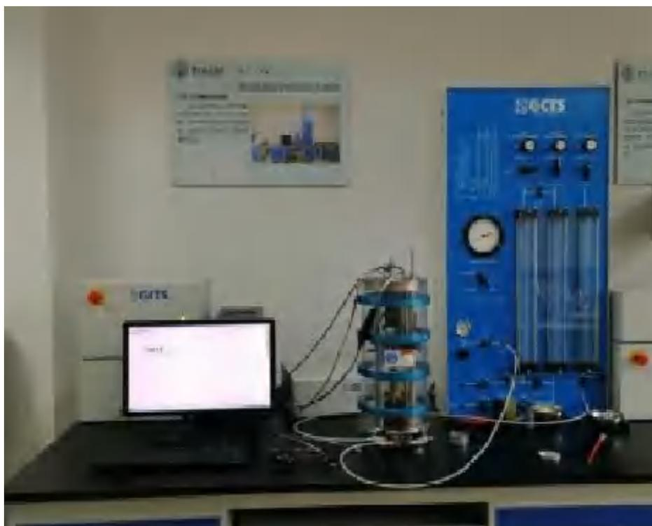
图 4.3.1 TSH-100 型共振柱测试系统设备全貌
