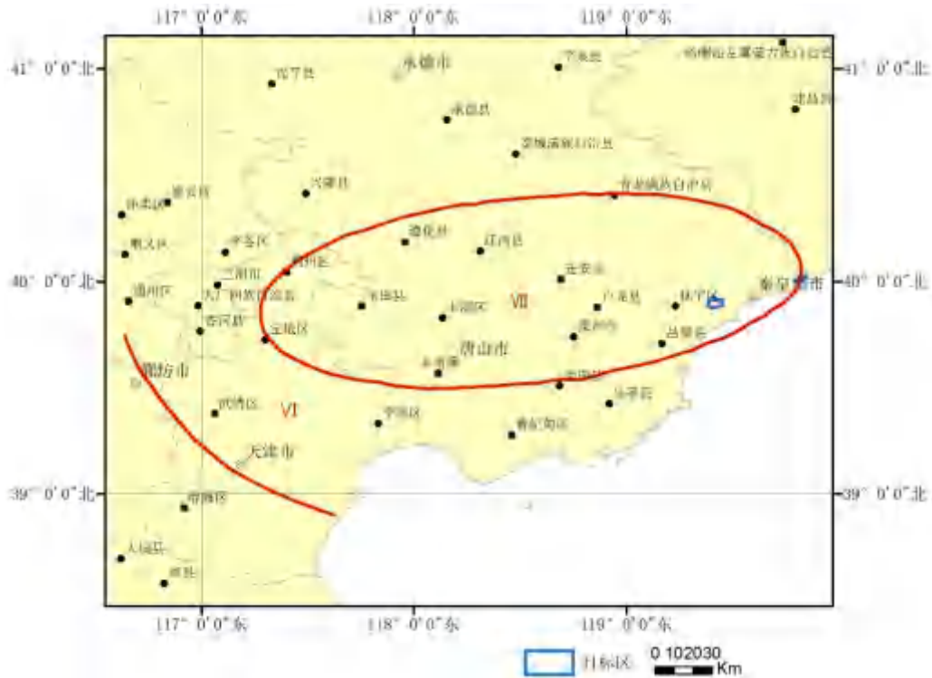
图 1.1.15 1624 年 4 月 17 日河北滦县 6\frac{1}{2} 级地震等震线图 (据《中国历史强震目录(公元前 23 世纪—公元 1911 年)》改编)
