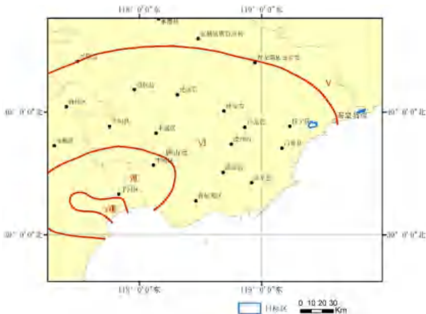
图 1.1.20 1976 年 11 月 15 日天津宁河西 6.9 级地震等烈度线图 （据《中国近代地震目录（公元 1912 年~1990 年， M_S \geq 4.7 ）》改编）
