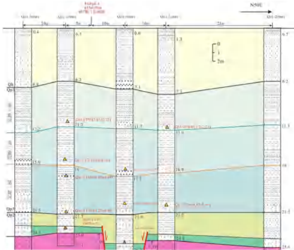
图 2.2.29 鸽子窝断裂 (建昌营断裂分支断裂) 跨断层钻孔探测综合解释图 (沙窝) (中国地震应急搜救中心, 2012)
